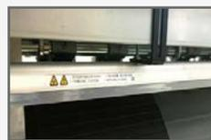
Dispositivo antiestática que asegura un posicionamiento correcto de las gotas de tinta.
