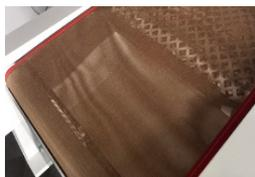
Gracias a su cinta transportadora, permite cortar archivos mientras imprime. El film ingresa mediante un sistema de succión de aire, permitiendo cortar durante la producción.
